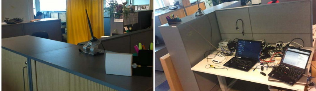
Kuva vasemmalla: antennit, oikealla: mittauspaikka, keltainen modeemi pöydällä vas. kulmalla. Sen takana valkoinen TW-3G Router.
